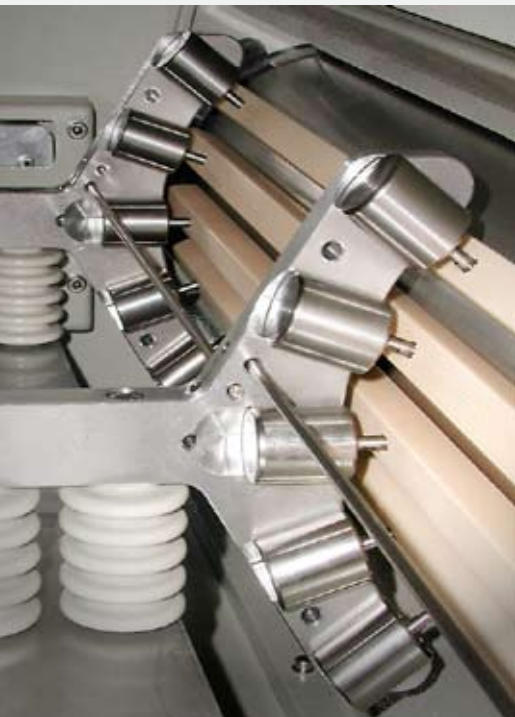
Keramik-Elektrode, an einzelnen Schwenkhaltern aufgehängt
